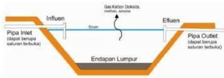
Gambar 2. 5 Ilustrasi Pengolahan pada Kolam Anaerobik
